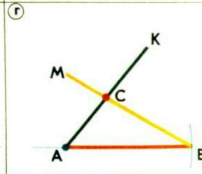
Построение треугольника по стороне и двум прилежащим углам.
