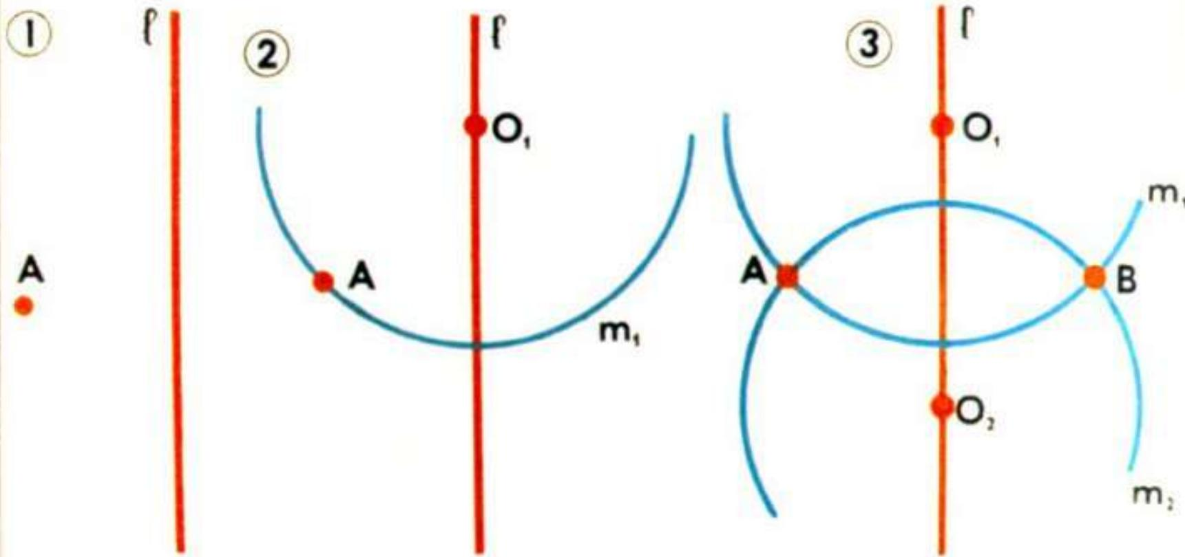
Точку, симметричную точке А относительно оси  $\ell$ , легко построить с помощью циркуля. Для этого надо через точку А провести две окружности с центрами на оси  $\ell$ . Почему точки А и В симметричны?
