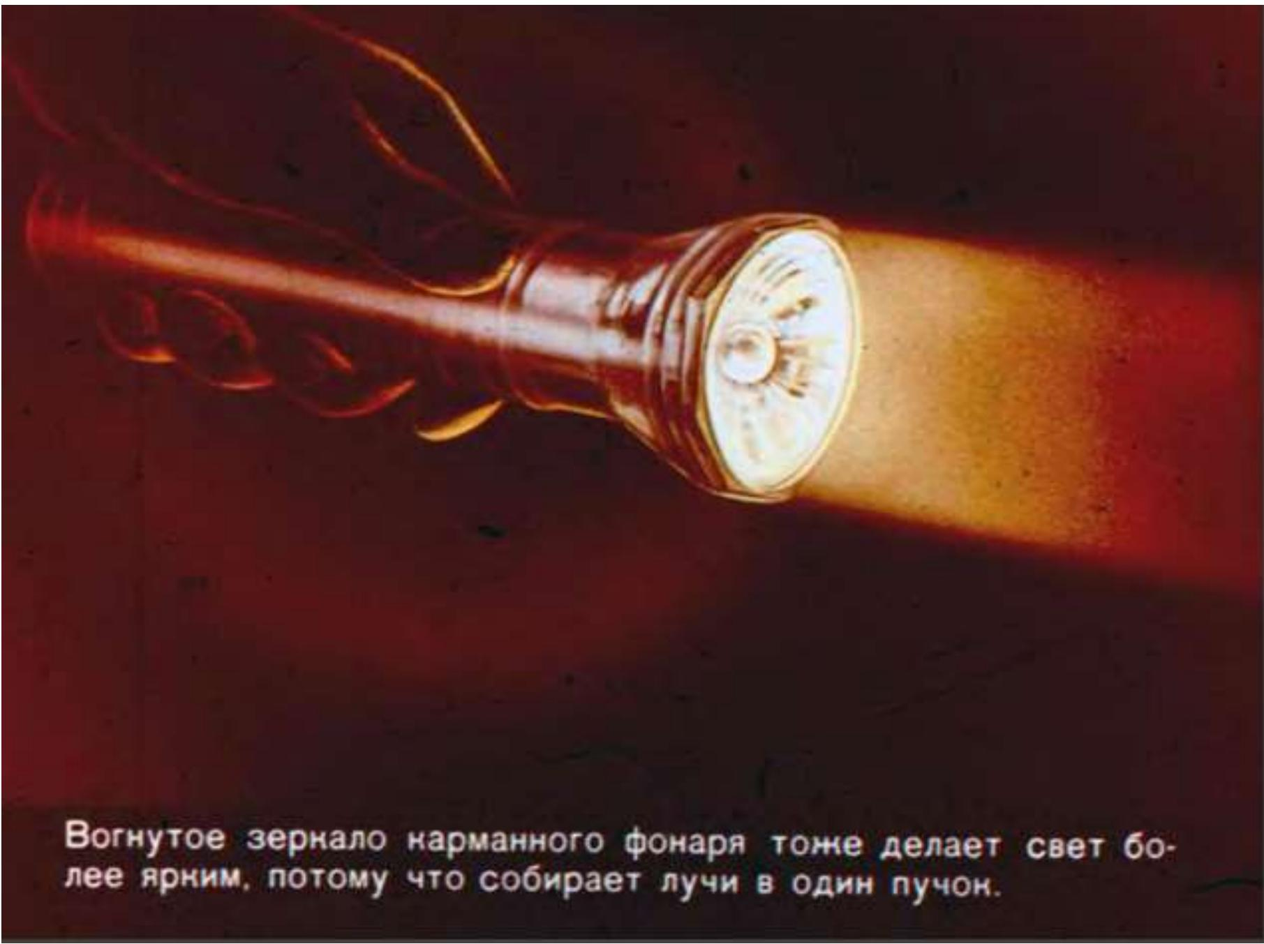
Вогнутое зеркало карманного фонаря тоже делает свет более ярким, потому что собирает лучи в один пучок.
