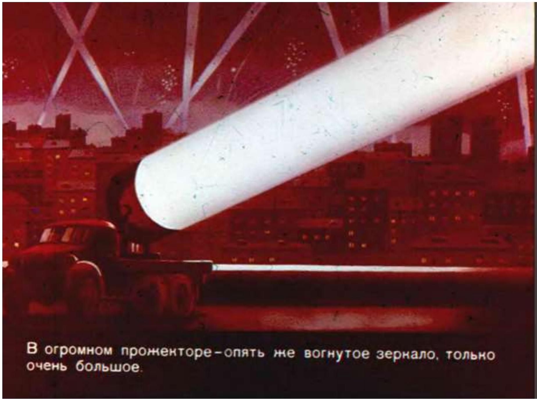
В огромном прожекторе - опять же вогнутое зеркало, только очень большое.
