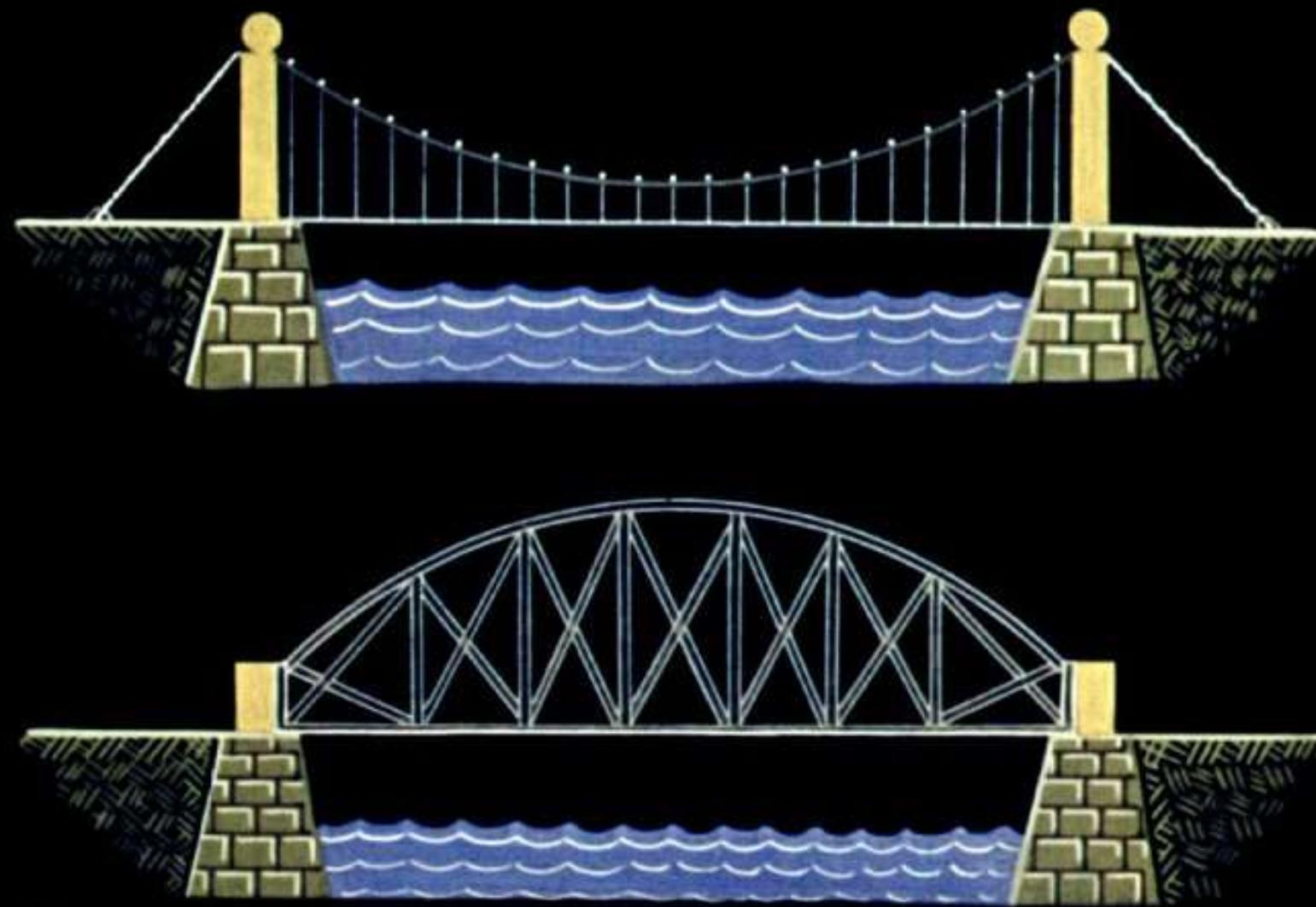
Канат висячего моста, некоторые мостовые фермы имеют параболическую форму.
